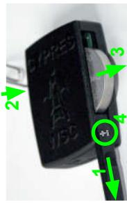
Inserire la nuova batteria (con il lato + verso l'alto) entro mezzo minuto dalla rimozione della vecchia, ed eseguire un test della batteria. Se non viene emesso nessun suono rimuovere nuovamente la batteria immediatamente perché potrebbe essere inserita al contrario oppure scarica. Correggere la situazione. Per un elenco di costruttori consultare [www.es.aero/wsc](http://www.es.aero/wsc).
