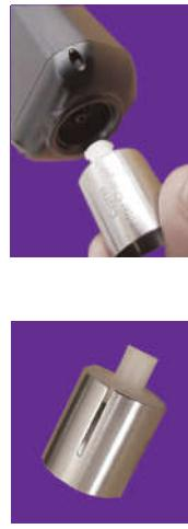
Impugnare il cambia-filtro dal lato senza scanalatura inserendo senza forzare il filtro nella sede apposita dell'unità di elaborazione, senza inclinarlo. Ruotare il cambia-filtro in senso orario, superando la leggera resistenza che si incontrerà all'inizio. Continuare a girare il cambia-filtro fino a quando il filtro non girerà più (il cambia-filtro continua a ruotare anche quando il filtro è bloccato in posizione). Rimuovere il cambia-filtro tirandolo senza inclinarlo.
