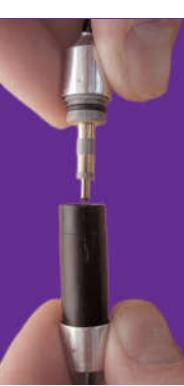
E' semplice convertire un CYPRES dalla versione per uno spinotto a quella per due spinotti o viceversa in quanto è sufficiente sostituire il tipo di cutter.
