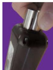
**Installazione del filtro:** Inserire il nuovo filtro all'interno del cambia-filtro con il lato etichettato verso la scanalatura fino alla posizione di fermo. Non inclinarlo.
